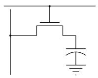
La célula DRAM de un sólo transistor consta de un transistor NMOS y un capacitor  $C_1$ , donde se guarda la información según su estado de carga.
