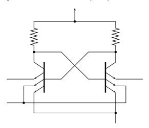
Esta célula consta de dos transistores acoplados en cruz, formando una báscula, en la que un transistor está en saturación y el otro al corte.
