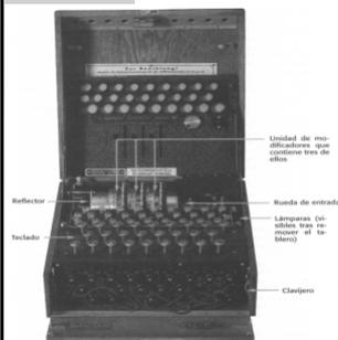
Al pulsar la b en el teclado, una corriente pasa al modificador, sigue el sendero del cableado interno y finalmente sale iluminando la lámpara A en el tablero, de forma que la b es codificada como A
